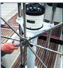
1. Steuerrad abnehmen, Halterung auf die Säule setzen
