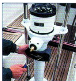
1. Steuerrad abnehmen, Halterung auf die Säule setzen
